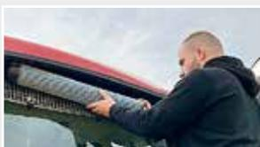
Einfach: Kabinenfilter ohne Werkzeug aus-/einzubauen.
