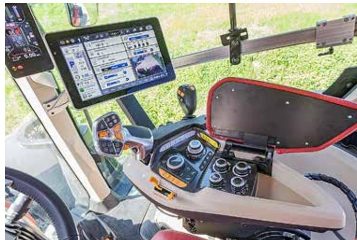
A-Holm-Anzeige und Terminal sind super klar, der Fahrhebel hat viele Knöpfe auf einer Ebene. Liebe zum Detail zeigt der kleine Dämpfer für den Deckel der Armlehne.
