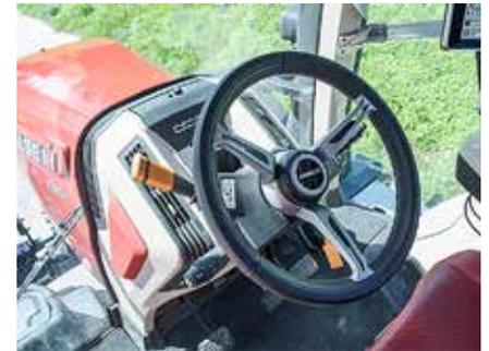
Das griffige Lenkrad und der Wendehebel mit Park-Stellung sind super, nur der Blinkerhebel sollte näher an das Lenkrad rücken.
