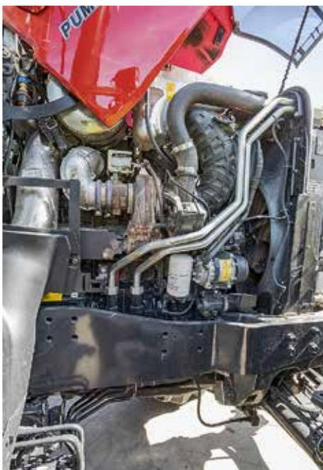
Der FPT-Motor überzeugt bei Leistung und Verbrauch. Und er hat nur im 260er einen Turbolader mit variabler Geometrie.
